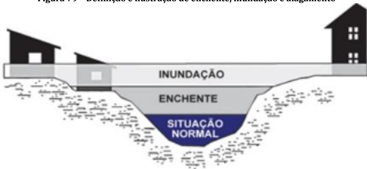
Figura 79 – Definição e ilustração de enchente, inundação e alagamento
