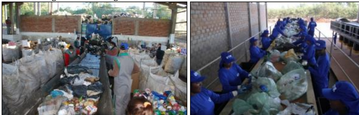
Figura 113 – Triagem manual de resíduos secos na esteira mecânica
