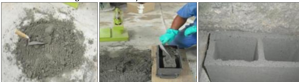
Figura 155 – Confeção do bloco com lodo de ETA
