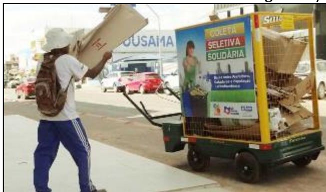
Figura 108 – Modelo de carrinho com motor de seis cavalos, a gasolina, utilizado na coleta seletiva solidária em Luiz Eduardo Magalhães/.
