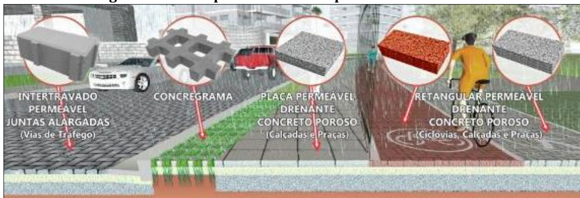
Figura 88 – Exemplo ilustrativo de pavimentos drenantes
