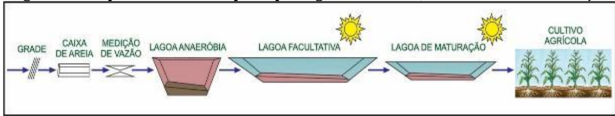
Figura 53 - Esquema de ETE composta por lagoas anaeróbia, facultativa e de maturação
